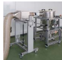
Aufbau eines Luftextraktions-Prüfstandes für luftführende Bauteile nach VDA 19.1 als weltweit erster Labordienstleister
