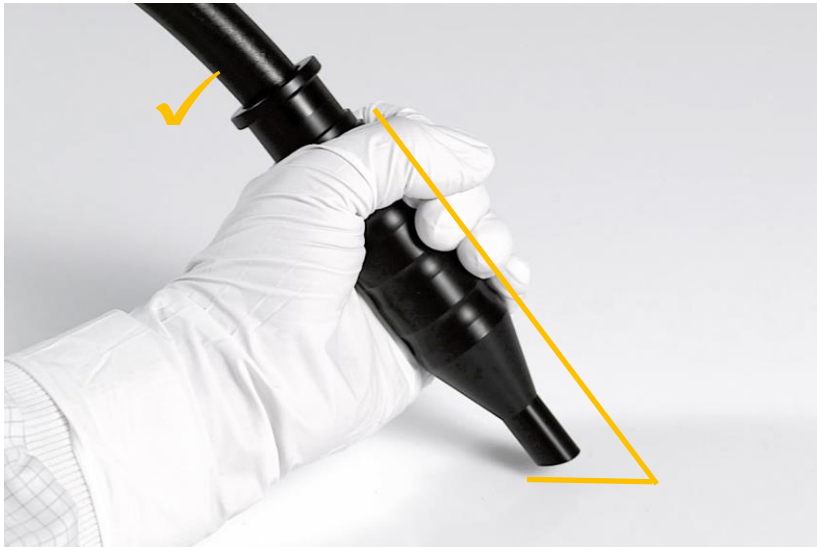
Korrektter Abstand und Schrägstellung der Saugdüse
