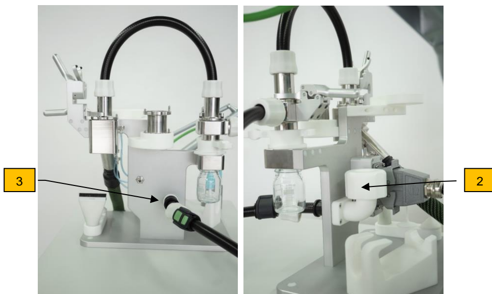
Blindwertermittlung, Absaugung mit Vorfilter über Trockenadapter
