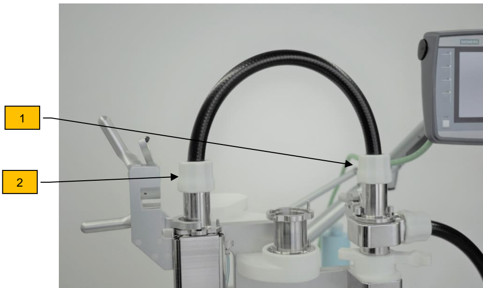
Zykloneinheit und Filtereinheit verbinden
