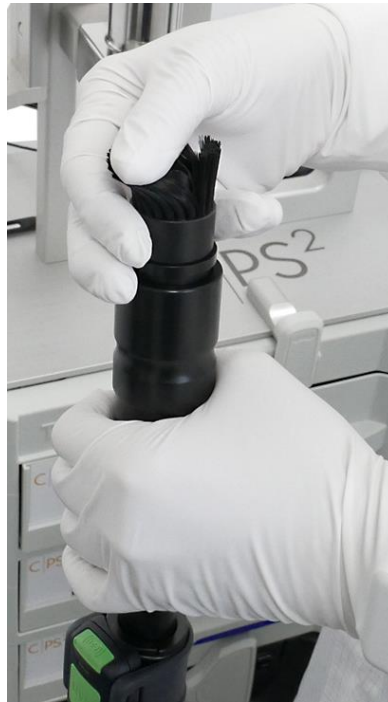
Bürstensaugdüse mechanisch vorreinigen
