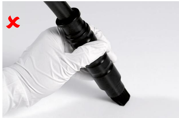
Falsches Aufsetzen der Bürstendüse
