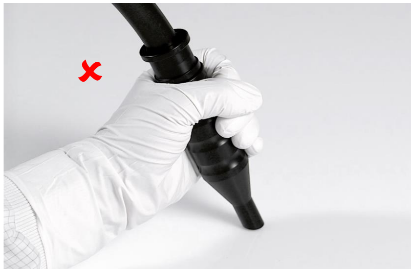
Falscher Abstand und Schrägstellung der Saugdüse
