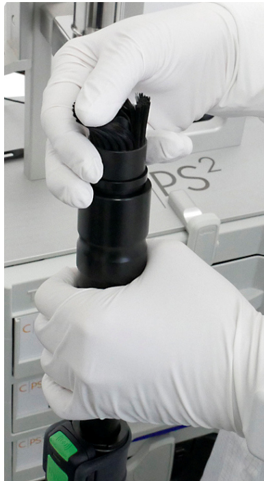
Bürstensaugdüse mechanisch vorreinigen
