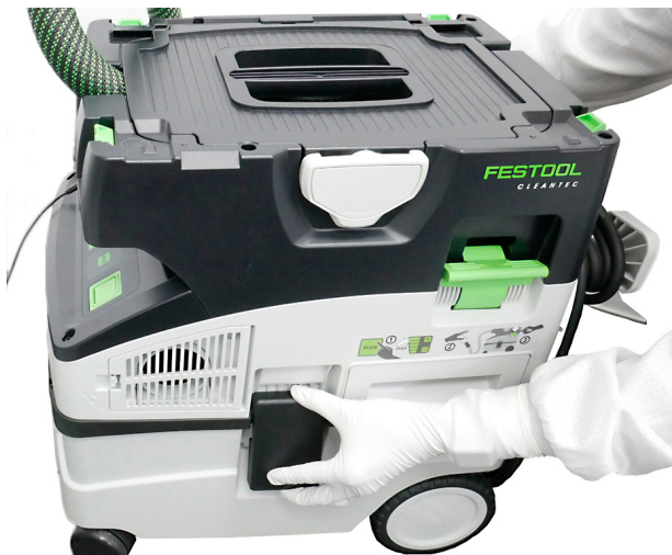
Filter der Saugereinheit wechseln
