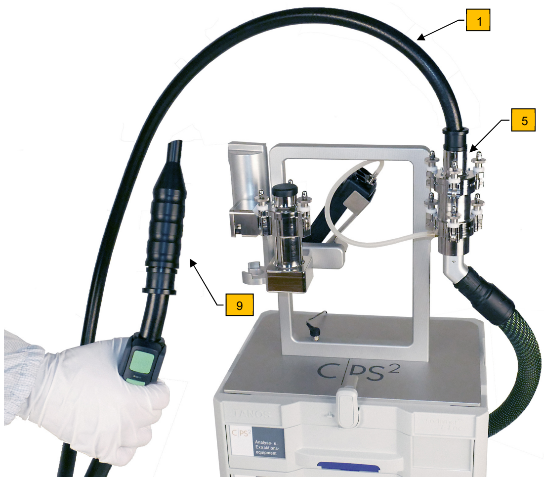
Saugschlauch anschließen und Saugdüse aufstecken
