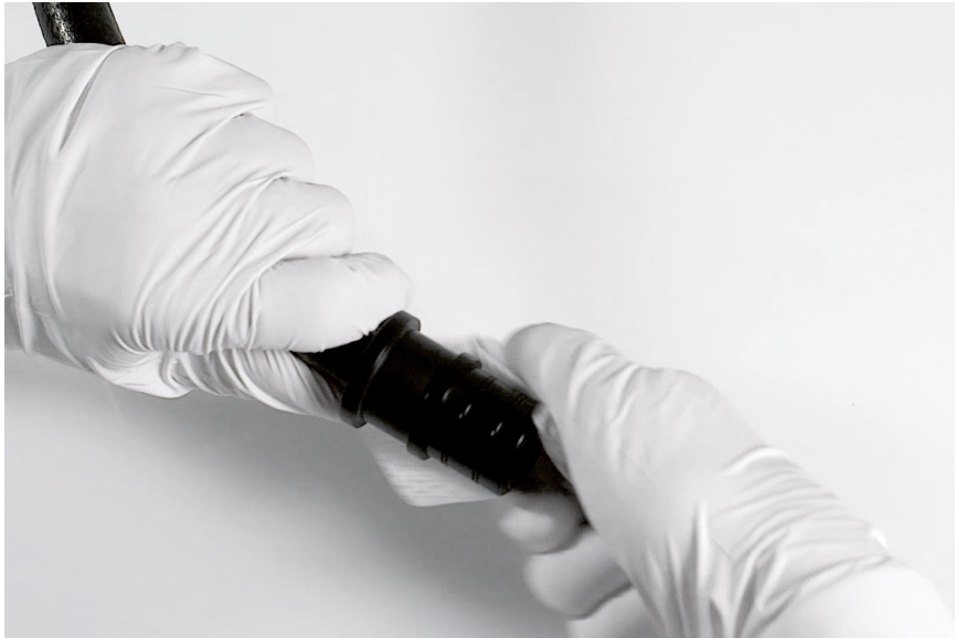
Reinigung der Steckbuchsen an den Schlauchenden
