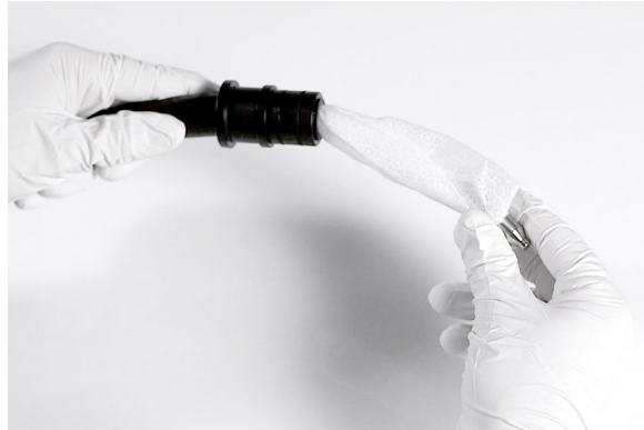
Hindurchgeführtes alkoholgetränktes Reinigungstuch
