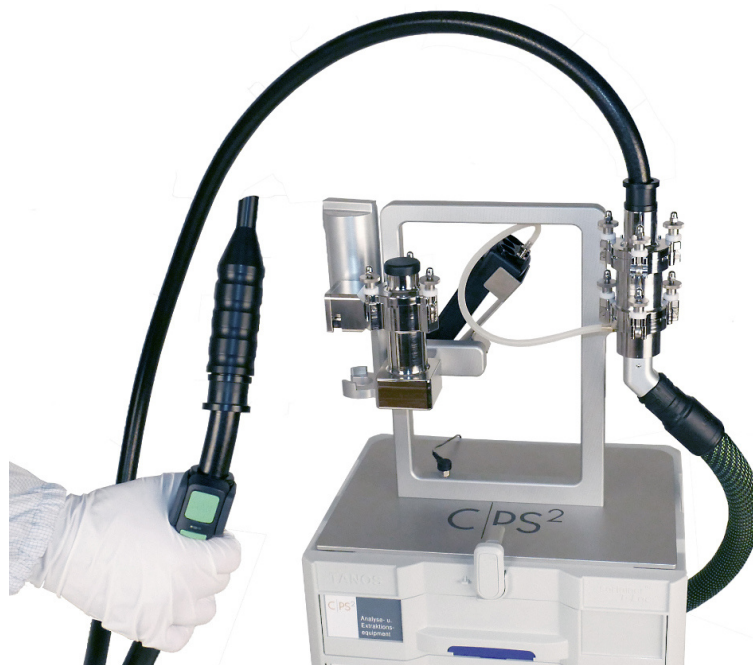
Blindwertermittlung, Absaugung gegen Atmosphäre
