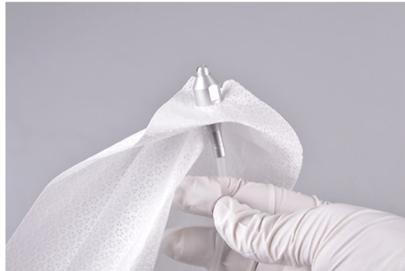
Reinigungsflitze mit befestigtem alkoholgetränktem Reinigungstuch
