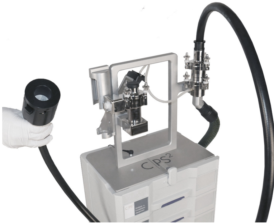
Blindwertermittlung, Absaugung mit Vorfilter
