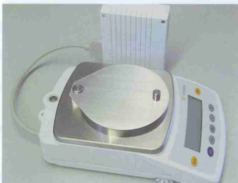
Die modifizierte Sartoriuswaage erfüllt nun genau die Anforderungen, die für die Restschmutzbestimmung verlangt werden.
