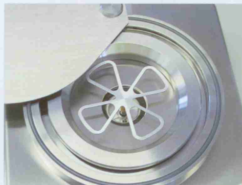
Der Zugang von oben in den Wägeraum sowie die Sternform der Filterwaagschale erleichtern u.a. das Handling mit einer Pinzette.
